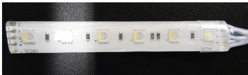
Fig. 35 - Elektronik för statusljus
